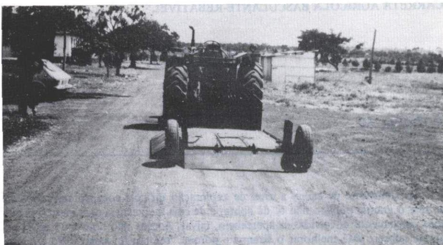
Carreta em posição rebaixada, com as laterais formando rampas, que facilitam a carga e descarga.
