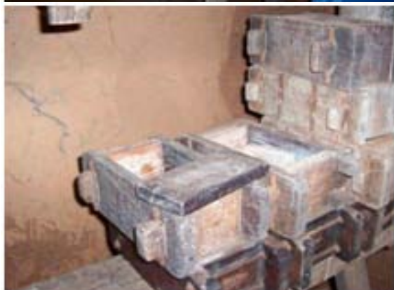
Figura 9. Fôrmas quadradas de madeira.
