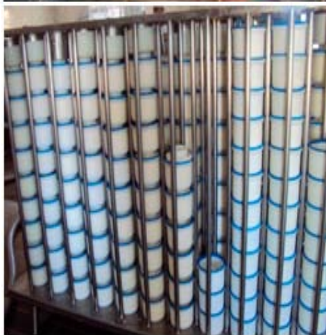
Figura 11. Fôrmas redondas de PVC.
