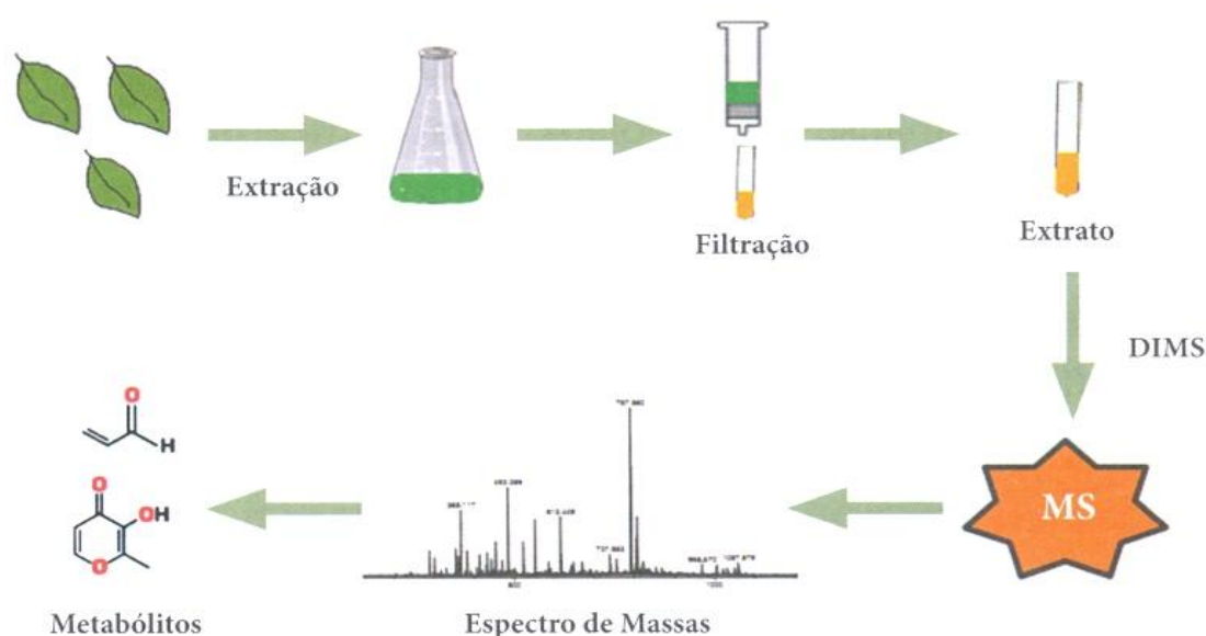
Figura 7. Fluxograma geral para estudo metabólico de folhas.
