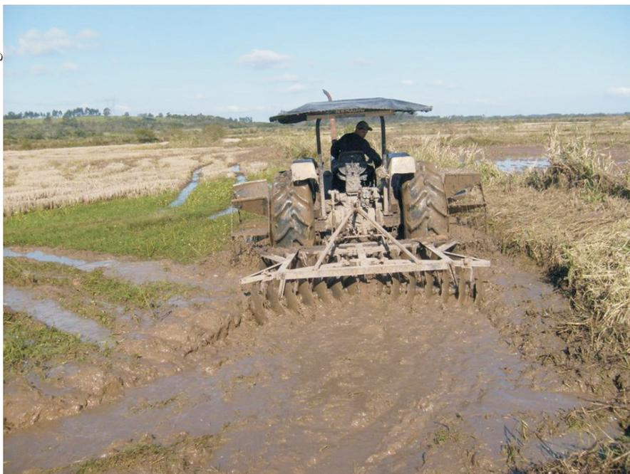
**Figura 4.** Gradagem mecânica para plantio de arroz.
