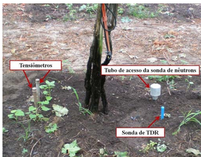
FIGURA 22 Foto dos tensiômetros, sondas de TDR e tubos de acesso da sonda de nêutrons instalados em torno das videiras.
