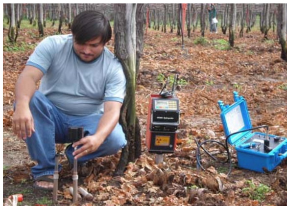
FIGURA 26 Monitoramento da água no solo utilizando o tensímetro de punção digital, a sonda de nêutrons e o TDR.
