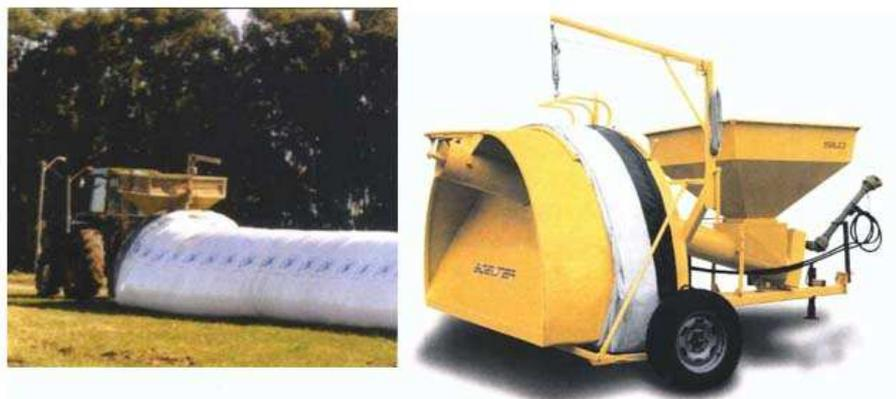
Fig. 4 Armazenamento hermético em Silos "BAG".
