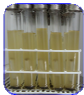
Figura 3 – Gases acumulados em tubos de Durham invertidos. Fonte: dos autores.
