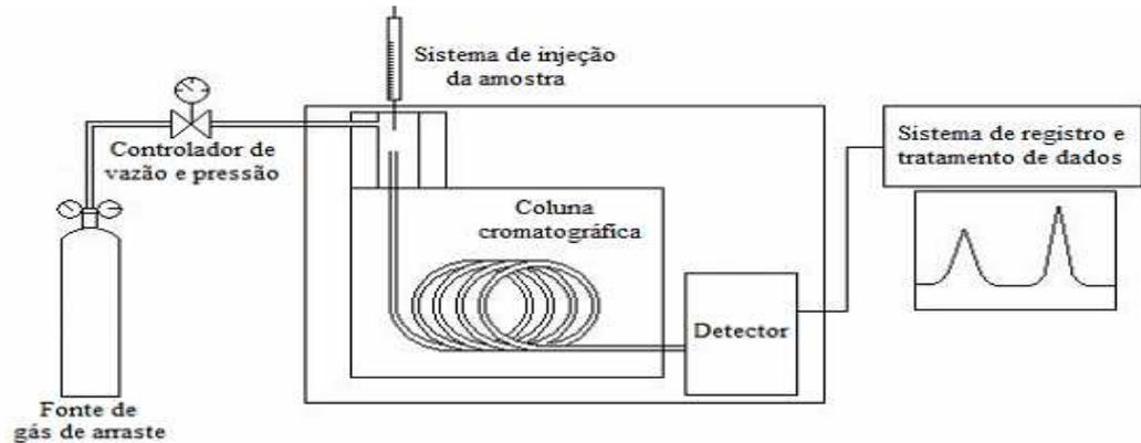
**Figura 4:** Componentes básicos de um cromatógrafo a gás. Adaptado de Bonato (2006).
