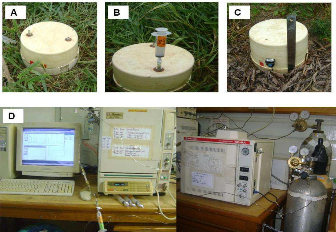
**Figura 8:** Foto A mostra a câmara, B seringa usada para coleta dos gases, C régua para medir a altura da câmara e termômetro para verificar a temperatura do solo, D sistema cromatográfico.
