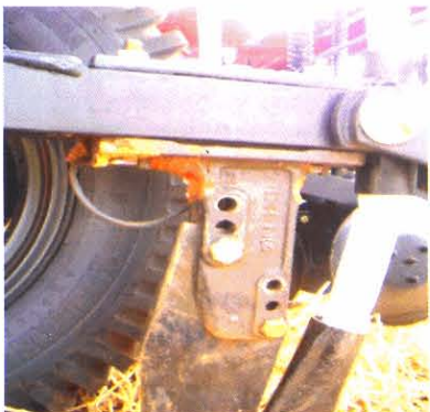
Figura 13. Sensor utilizado para medição da força de tração requerida por hastes sulcadoras para deposição do adubo.
