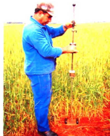
Figura 12. Penetrômetro de impacto construído conforme Stolf et al. (1983).
