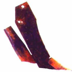
Figura 26. Exemplo de haste sulcadora com ponteira estreita e ângulo de ataque próximo a 20°.
