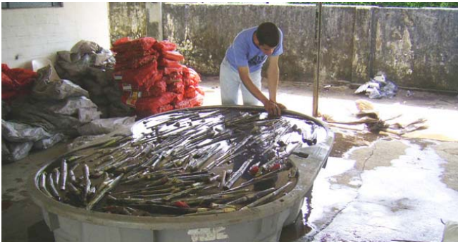
Fig. 3. Tanque utilizado pela imersão dos colmos. Colmos pré-selecionados para o ensaio.
