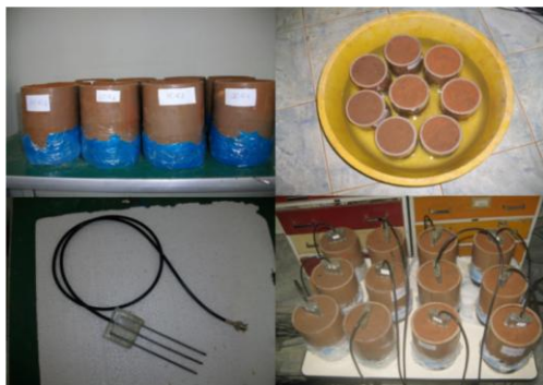
Figura 1 Detalhe da calibração das sondas de TDR com as hastes inseridas completamente no solo após 48 horas de saturação, Cruz das Almas-BA, 2011.
