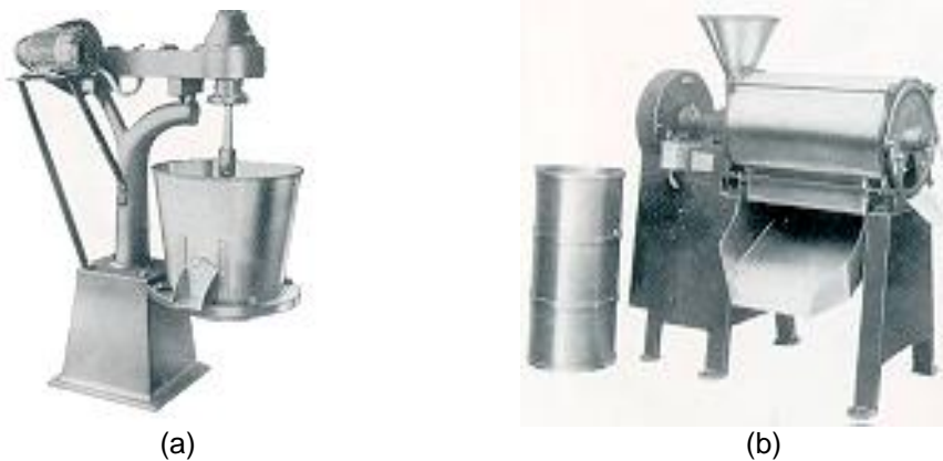
FIG. 3. Alguns tipos de despulpadeiras para frutas (a) despulpadeira vertical e (b) despulpadeira horizontal simples.
