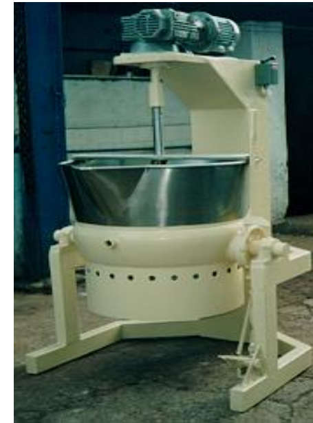
FIG. 7. Tacho aberto, a gás, com misturador, utilizado na concentração de geléias.
