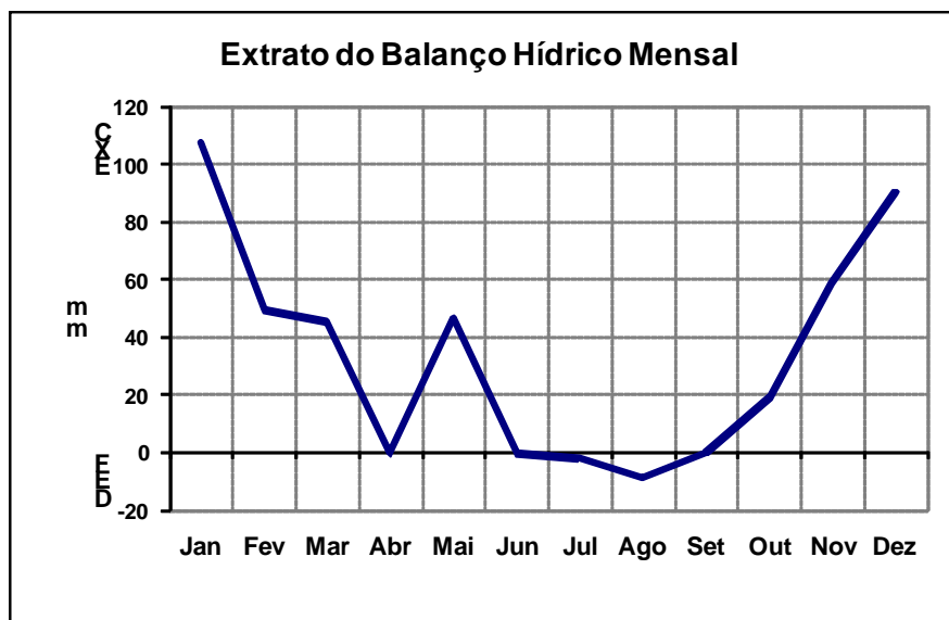
FIGURA 2. Representação gráfica do balanço hídrico para o município de Campo Grande (MS).
