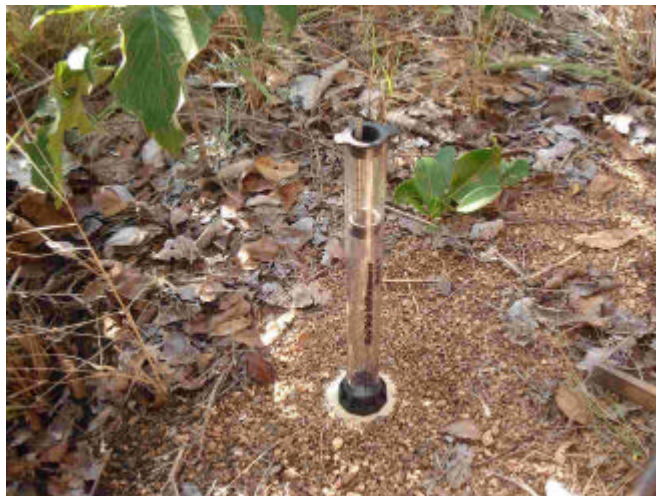
Figura 2. Teste de infiltração com infiltrômetro portátil. Pode ser observado o pavimento pedregoso.
