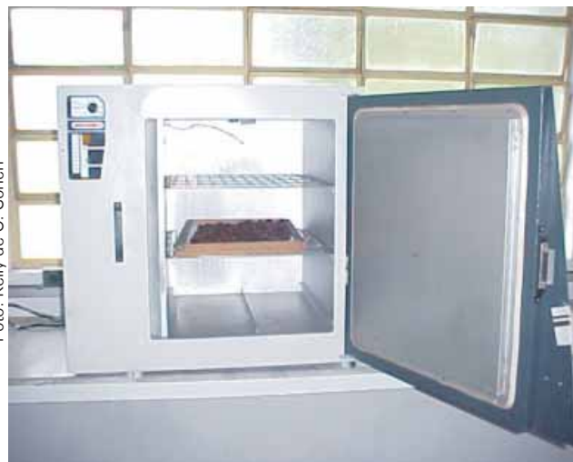
Fig. 3. Castanha-do-brasil secas em estufa com circulação de ar.
