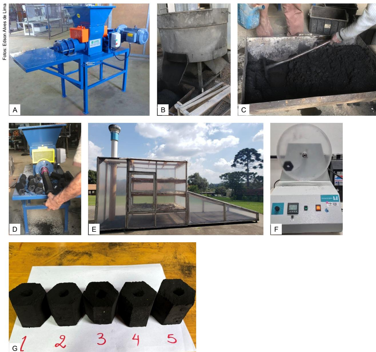
**Figura 1.** Moedor de carvão MOR-04\*, capacidade de 500 kg/h. (A); peneiramento (B); homogeneização manual dos finos de carvão com o aglutinante e água (C); produção dos briquetes sextavados com orifício (D); secador solar utilizado para a secagem dos briquetes (E); friabilômetro para o teste de friabilidade (F); corpos de prova para a determinação da densidade aparente(G).
