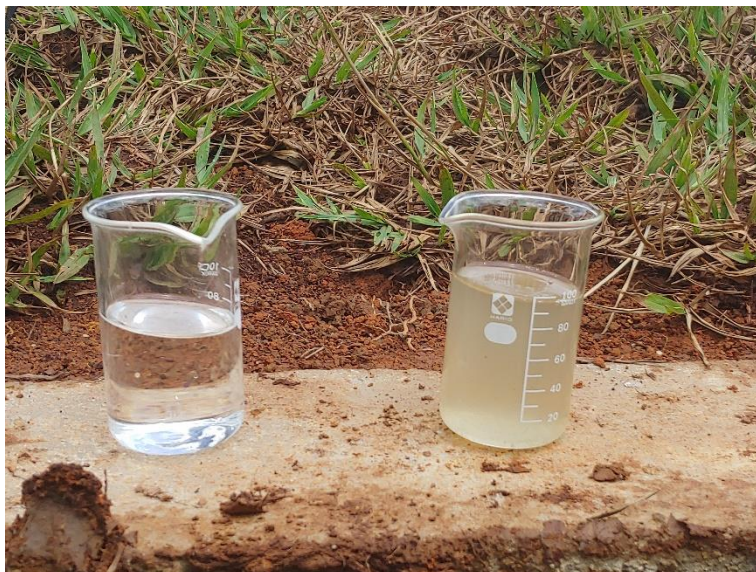
Figura 6 – Imagem de amostra de efluente coletada no Tanque Séptico (à direita) e da água de reuso (à esquerda) produzida pelo Sistema ReAqua.
