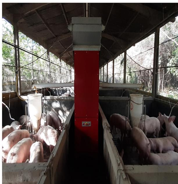
**Figura 1.** Sistema de distribuição de ração automatizada através de robô.
