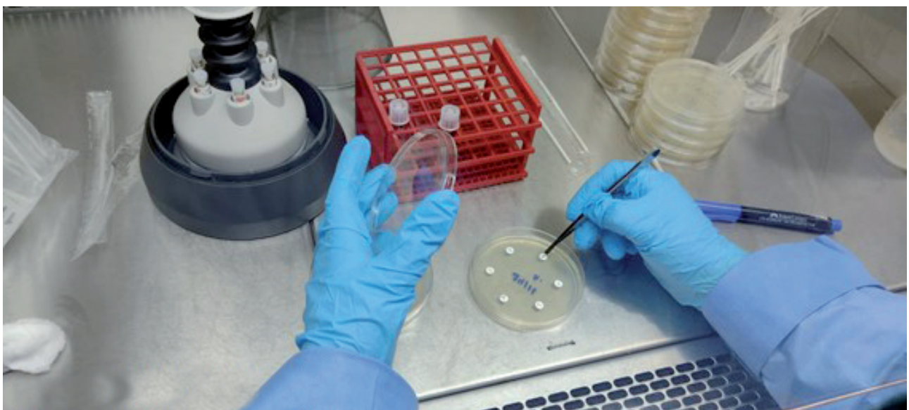
Figura 5. Dispensa manual de discos com auxílio de pinça esterilizada.
