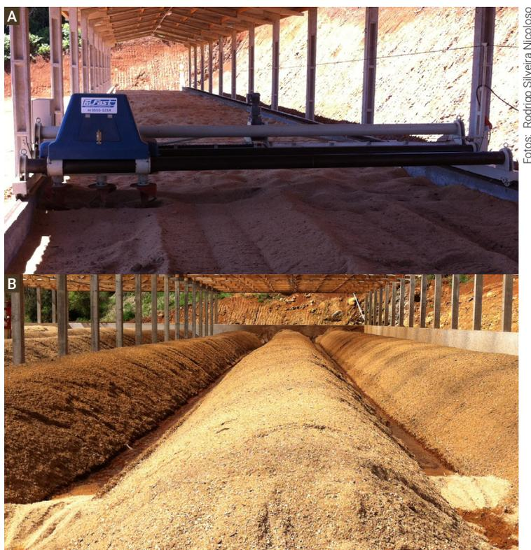
**Figura 2.** Compostagem de dejetos de suínos em plataformas (A) e em leiras (B) com revolvimento mecânico do material.
