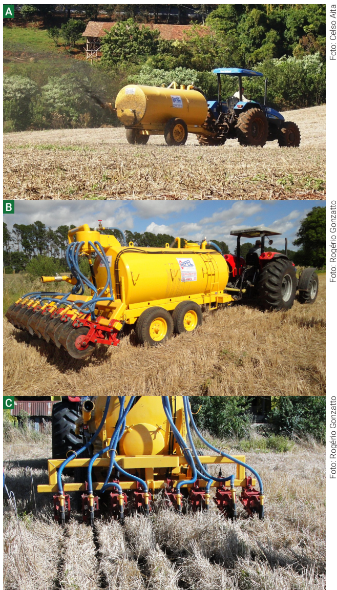
Figura 2. Visualização do distribuidor de adubo orgânico líquido (DAOL®) da empresa MEPEL Máquinas e Equipamentos Ltda. (a), a partir do qual foi desenvolvido o distribuidor de adubos orgânicos líquidos com incorporador (DAOL-i®) (b), para a injeção subsuperficial de dejetos líquidos em sulcos no solo (c), em sistema de plantio direto.
