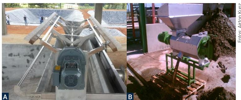
**Figura 2.** Peneira estática de escovas rotativas (A) e prensa-parafuso (B).
