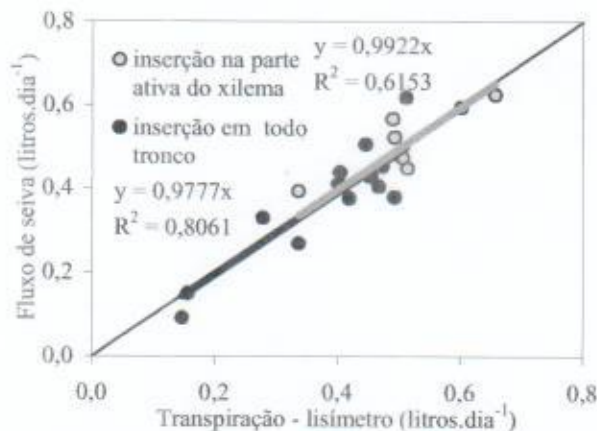
Figura 3. Fluxo de seiva com sensor inserido em todo o tronco e calculado considerando como toda a secção transversal do caule como condutora. Sensor inserido na área da secção condutora de seiva considerando para cálculo do fluxo apenas a área verdadeiramente condutora
