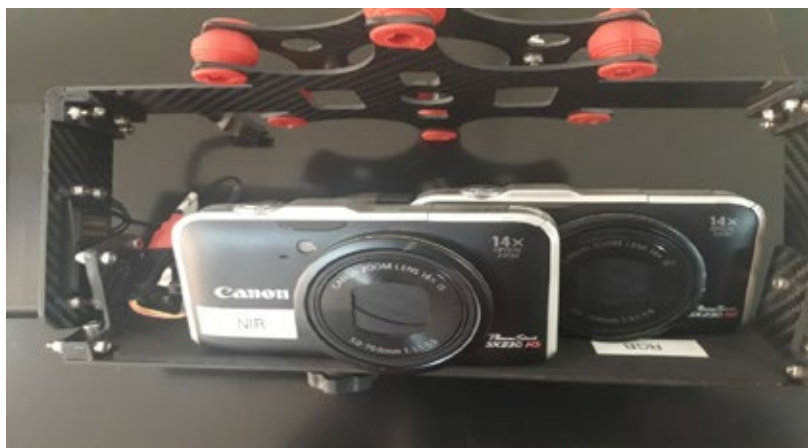
Figura 1. Câmera modificada com os filtros Red, Green e NIR (RGNIR) modelo Canon SX230.
