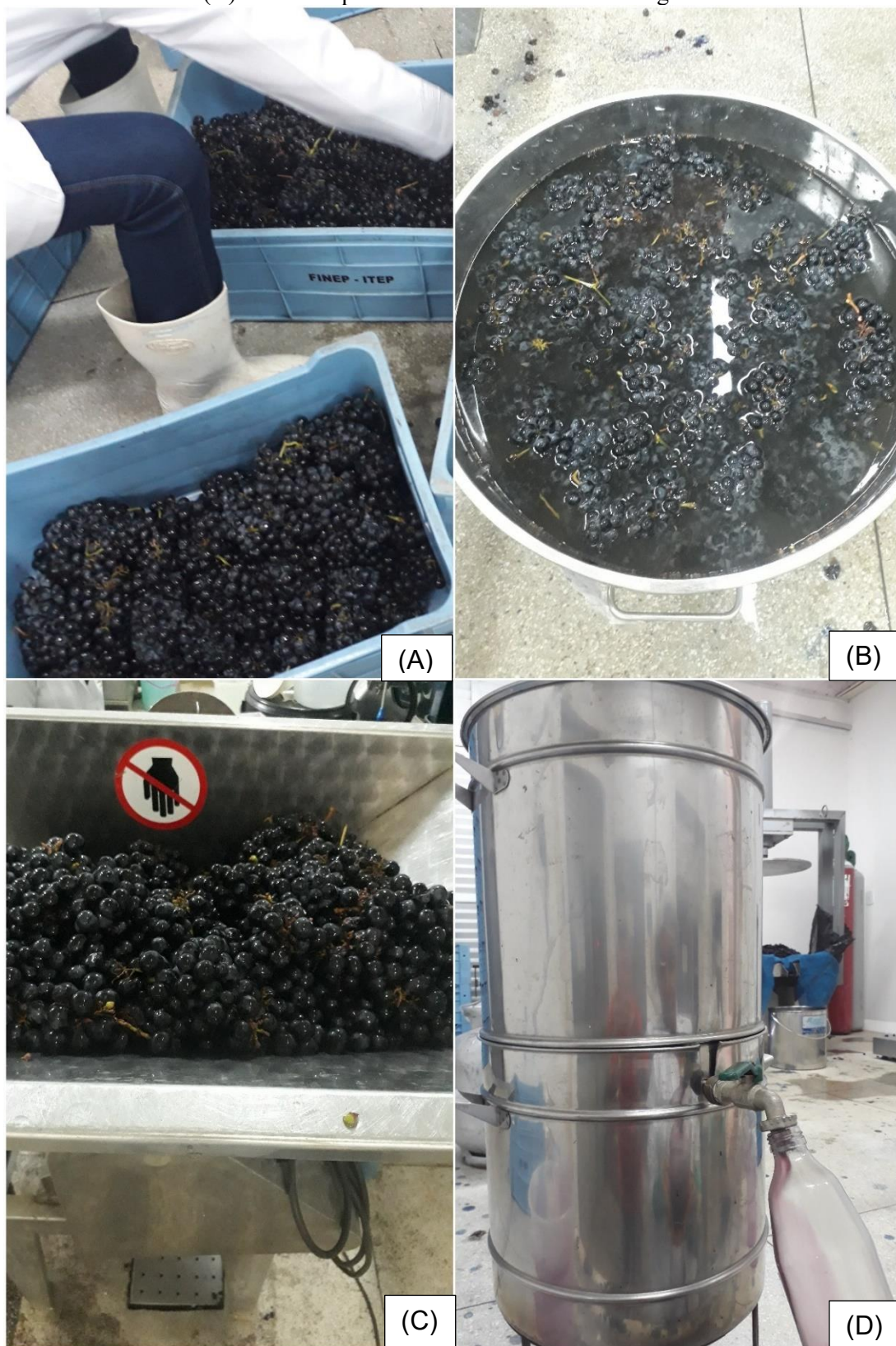
Figura 10 - (A) Seleção das uvas a partir da retirada de folhas, cachos com podridão e bagas verdes. (B) Lavagem e sanitização dos cachos de uva. (C) Desengace e esmagamento das uvas. (D) Envase a quente do suco de uvas ‘BRS Magna’.
