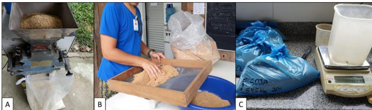
Figura 4- A: Moagem dos ingredientes e moinho de faca. B: Ingredientes peneirados em peneira de 1 mm. C: Pesagem dos ingredientes das rações experimentais
