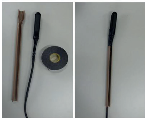
Figura 1 – Cabo de PVC previamente confeccionado, transdutor linear e fita adesiva; transdutor já fixado no cabo de PVC com fita adesiva.
