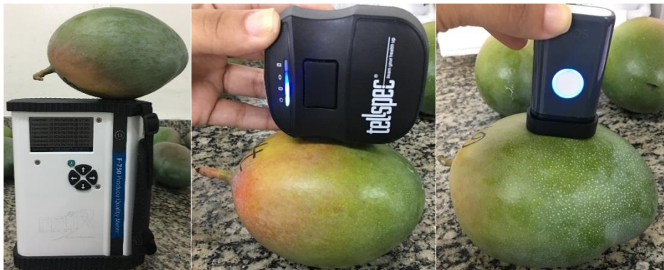
Figura 10 - Registro dos espectros utilizando os espectrômetros F-750, Telspec e Scio.
