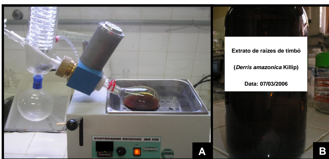
Figura 10. Evaporador rotativo MA 120 (A) e extrato de raízes de timbó acondicionado em recipiente de vidro âmbar hermeticamente fechado (B). Fotos: Alécio, M.R. (2006).
