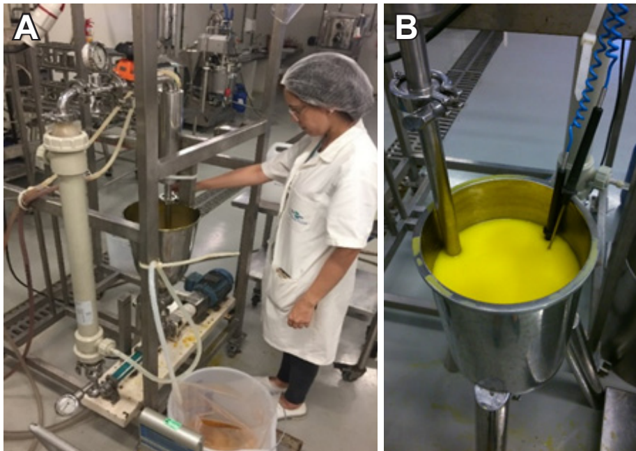
Figura 3. Processo de microfiltração (A) para obtenção do extrato concentrado de carotenoides (ECC) (B).
