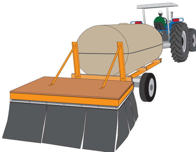
Figura 5. Desenho esquemático do protetor de deriva acoplado a um trator.
