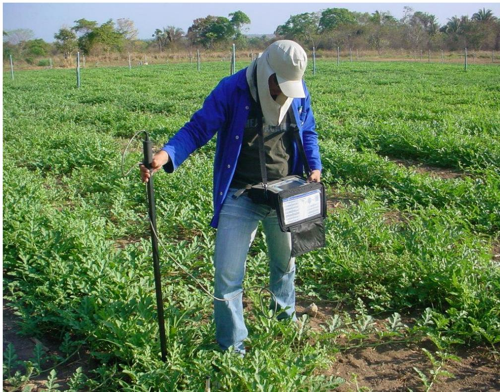
**Figura 10.** Detalhe do procedimento de leitura com o equipamento Diviner 2000<sup>®</sup>
