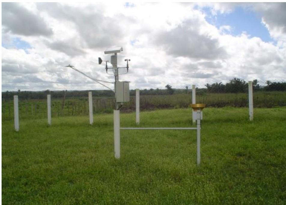
**Figura 9.** Estação agrometeorológica automática da Embrapa Meio-Norte. Teresina, PI.
