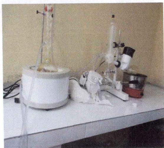
Sistema de Rota-Evaporação do Solvente
