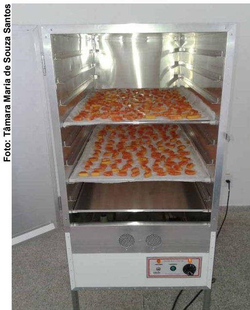
Figura 4. Desidratação do mamão em secador convectivo a 70 °C.
