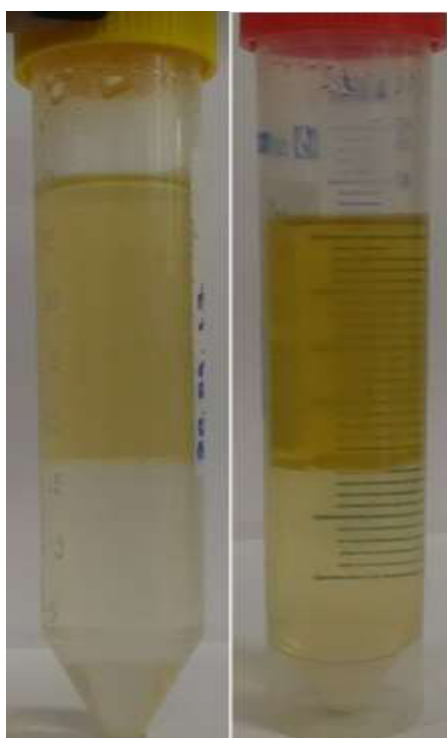
Figura 8 - Sistema aquoso bifásico formado por Etanol/(NH 4 ) 2 SO 4 (à direita) e Etanol/K 2 HPO 4 (à esquerda)
