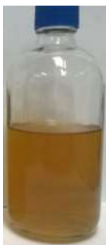
Figura 6 - Extrato obtido no ESP com etanol e água na proporção 60:40 (v/v)
