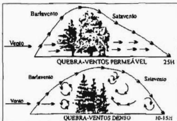
FIG. 29. Diferença entre a ação aerodinâmica de uma barreira permeável e uma densa. (Adaptado de Rosemberg, 1974).
