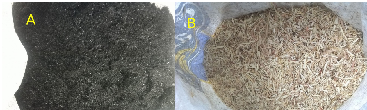
Figura 1. Cinza de casca de arroz peneirada (A); bagaço de cana-de-açúcar após extração do caldo (B). Fonte: Thais Wacholz Kohler.
