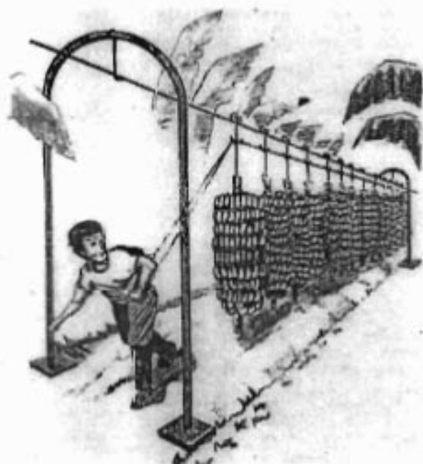
FIG. 61. Transporte dos cachos em cabos aéreos. Fonte: Soto Ballestero (1992).
