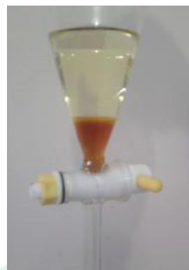
Figura 3 – Separação das fases de biodiesel e glicerol.
