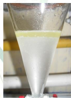
Figura 4 – Processo de lavagem do biodiesel com solução saturada de sulfato de sódio
