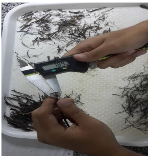
Figura 7- Mensuração do diâmetro das raízes utilizando um parquímetro digital.
