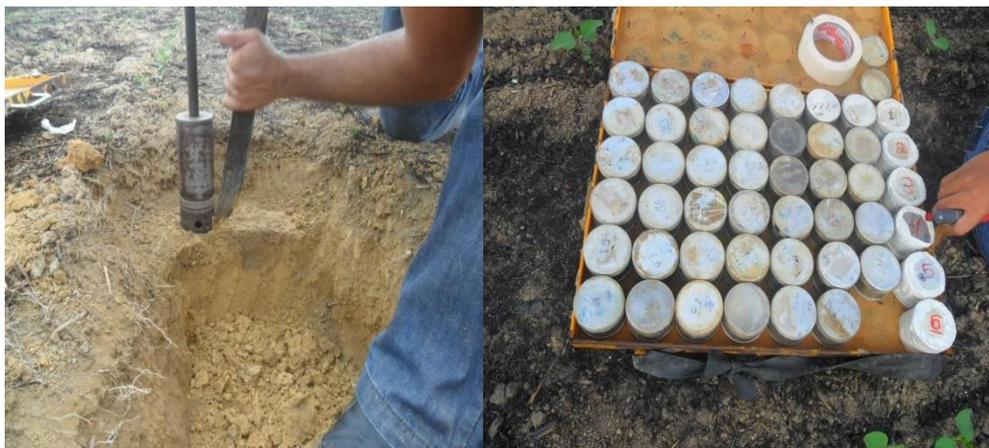
**Figura 6:** Coleta de amostras físicas indeformada utilizando-se trado do tipo Uhland e anéis volumétricos, em Paragominas-PA.
