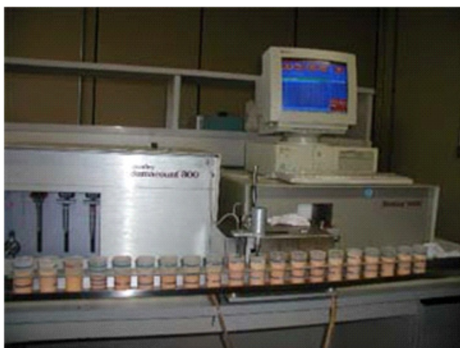
Figura 2. Realização da contagem de células somáticas em amostras de leite por meio de citometria de fluxo em equipamento automatizado (Bentley Somacount 300).
