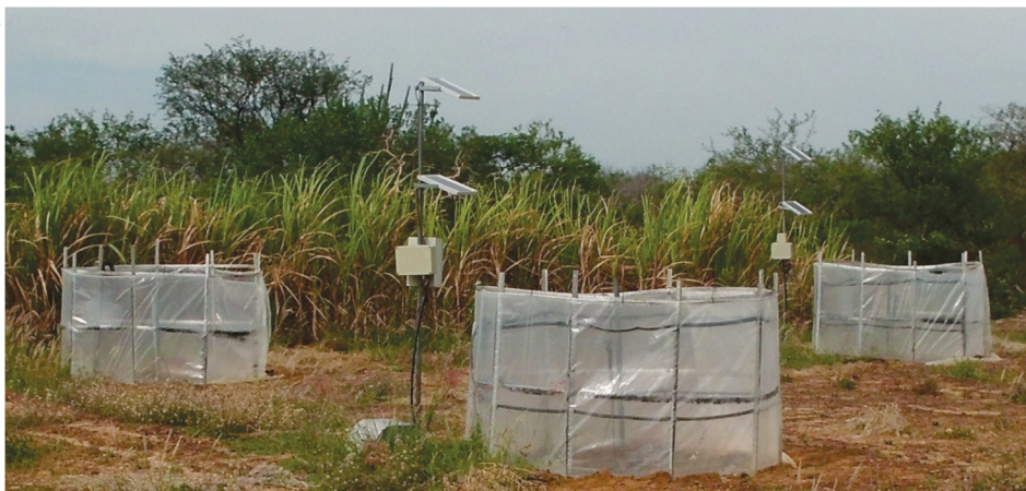
Figura 4. Câmaras de injeção de \text{CO}_2 utilizadas para o cultivo do meloeiro. Petrolina, PE.
