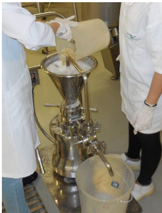
Figura 1. Ingredientes sendo adicionados ao moinho coloidal para preparação do extrato de amêndoas de castanha-de-caju.
