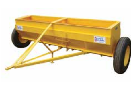
Figura 8 – Formas de aplicação dos remineralizadores: a) distribuição a lanço com discos centrífugos, b) distribuição por gravidade tipo “cocho”; c) semeadora com sulcador, caixas e dosadores para fertilizantes; d) aplicação manual.
