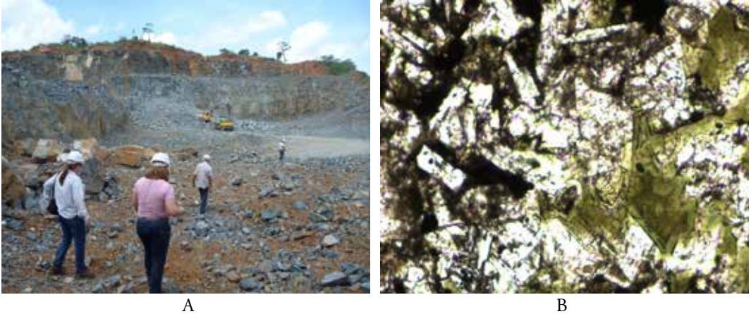
Figura 1 – A: Lavra da BV Mineração em Nova Olinda, próximo à capital Boa Vista. B: Fotomicrografia Luz Natural, aumento de 100 x de basalto da lavra com argilominerais da família das esmectitas (verdes) em cavidades e sobre grãos de plagioclásio. Domínios vítreos em cor escura.
