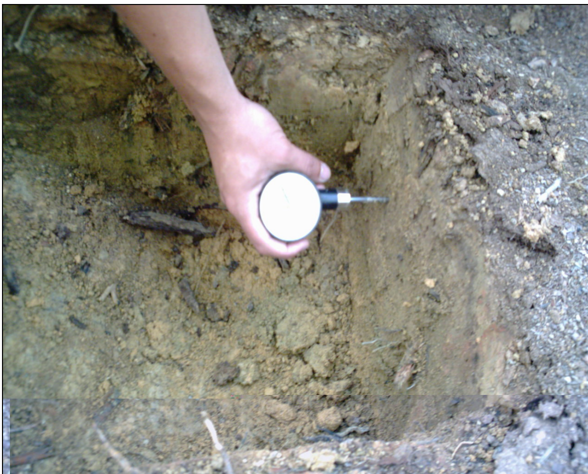
Figura 12 - Trincheira aberta para medidas de resistência do solo à penetração nas profundidades de 0-5, 5-10, 10-20 e 20-30 cm.
