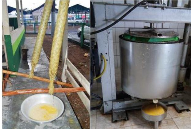
**Figura 4:** Prensa manual (tipiti) e prensa mecânica.
