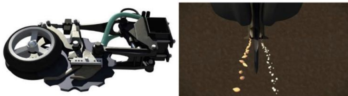
Figura 12. Unidade de semeadura e adubação para plantio direto Cross-Slot.
