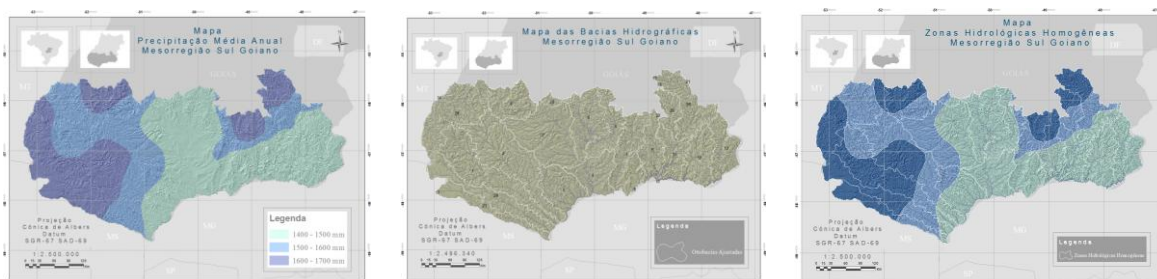
Figura 2 - Mapas: (A) Precipitação média anual (adaptado de Evangelista (2011)); (B) Modelo de bacias hidrográficas (Adaptado do sistema de Ottobacias n° 5 adotado pela ANA); (C) zonas hidrológicas homogêneas utilizadas para a elaboração do modelo de regionalização de vazões específicas para a Mesorregião Sul Goiano – GO (Ferraz, 2012)
