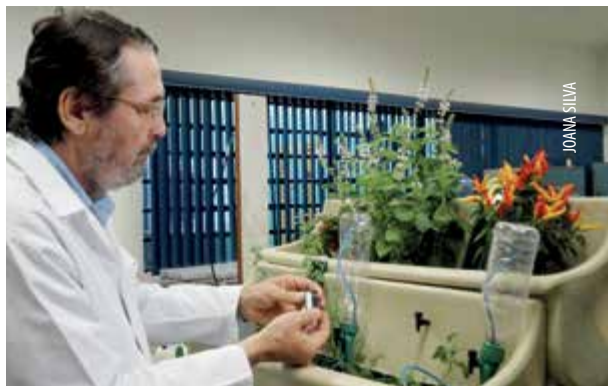
Sensor diédrico para medir a umidade do solo e substratos
